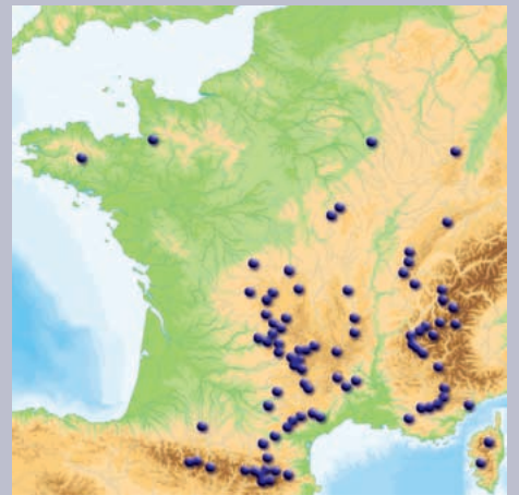
En France, les grands barrages sont les barrages de plus de vingt mètres de hauteur au-dessus du terrain naturel (point le plus bas) et de plus de quinze millions de mètres cubes de capacité de retenue.
